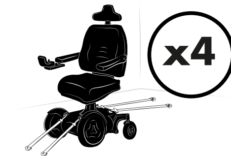
Foto 166. La silla de ruedas tiene cuatro puntos de amarre. La silla de ruedas y la posición de amarre en esta imagen son genéricas.
