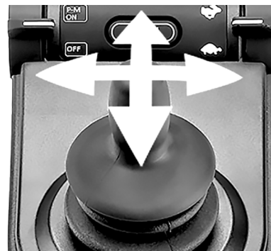
Foto 51. Con el uso del joystick Bluetooth® puede controlar las funciones del mouse.
