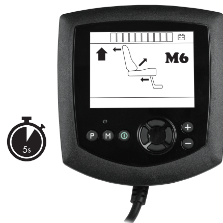
Foto 106. Mantenga activado el comando de avance durante 5 segundos.
