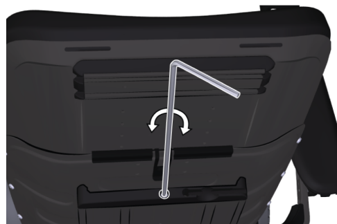
Foto 135. Utilice la manivela de ajuste suministrada.
